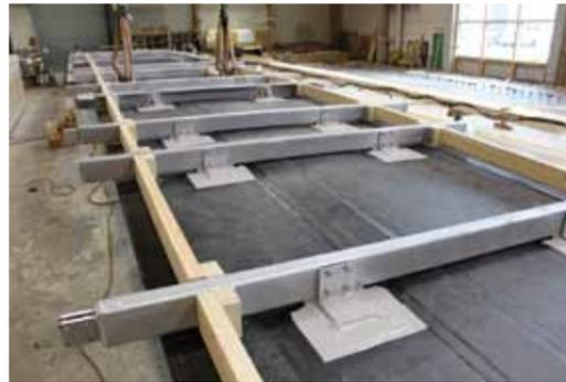
Die Abdichtung und die Grundkonstruktion aus Rechteckhohlprofilen wurden werksseitig aufgebracht. So konnte bereits für den Transport und während der Montage der konstruktive Holzschutz gewährleistet werden.
