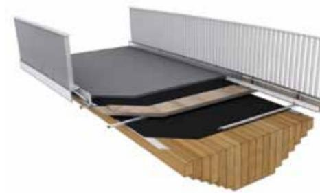
Testentwurf: Isometrische Darstellung Brückenüberbau und Gehbelag sind konstruktiv entkoppelt, so können die Ausbauelemente standortspezifisch entwickelt werden.
