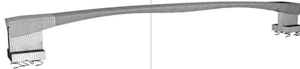
[1] Statisches System: die geometrische Form ist exakt erfasst, über die Federlemente am Widerlagerfuß werden die Bodenkennwerte berücksichtigt
