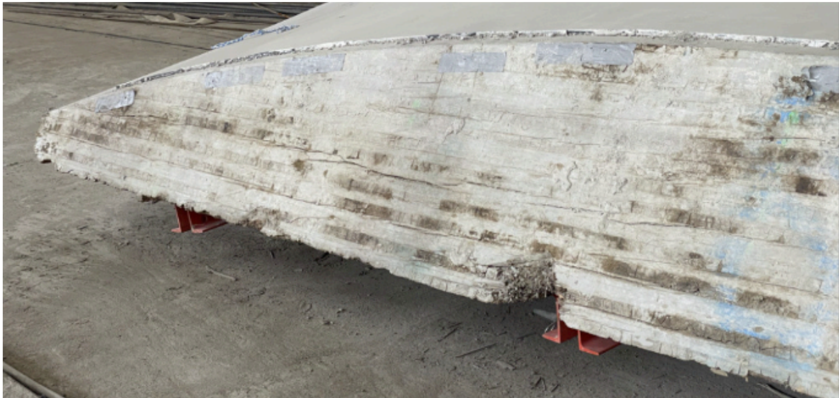
Abb. 38: Schadensbild nichtintakter Klebefugen und Fehlstelle, Foto: Tim Siemens
