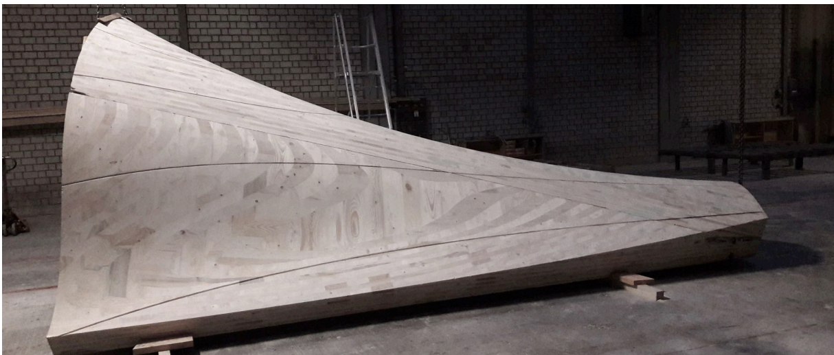
Abb. 14: Damaszenerstahlartige Holzoberfläche durch das dreidimensionale Abfräsen kreuzweise verleimter Brettlagen; Foto: Stefan Mederle
