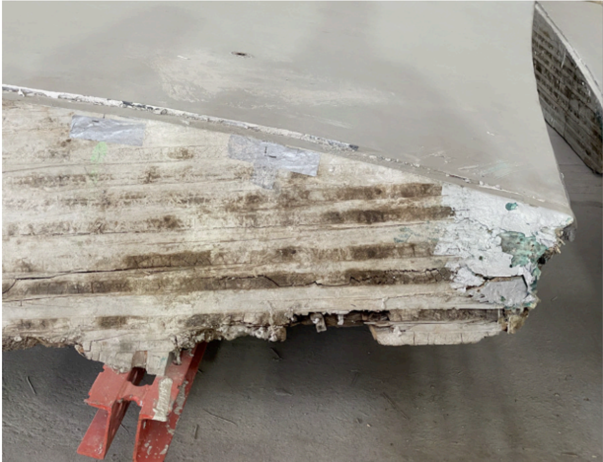
Abb. 37: Schadensbild aufgequollener und verwitterter Brettlagen, Foto: Tim Siemens
