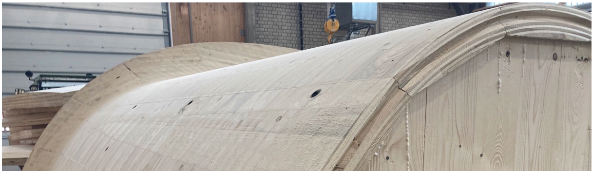
Abb. 12: Seitliche Nut zum Einlegen von Kompribändern zu Herstellen wasserdichter Schalungsstöße; Foto: Stefan Krötsch
