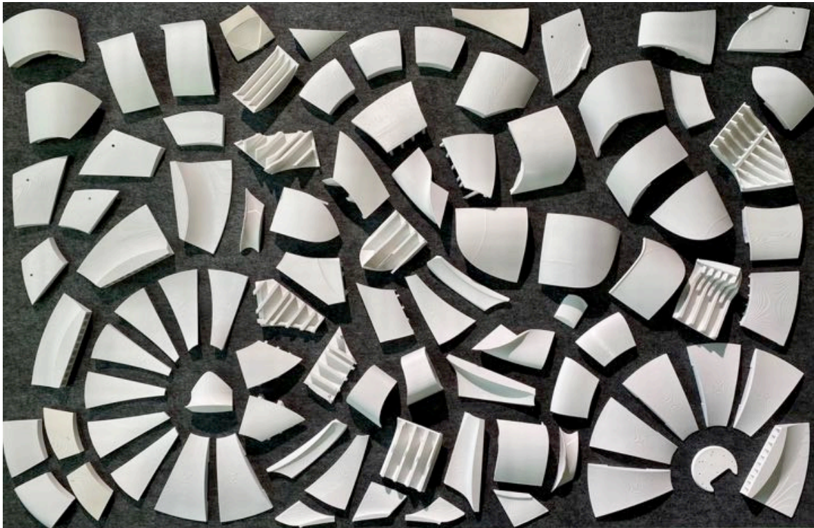
Abb. 7: 3D-Drucke ausgewählter Schalungselemente; Foto: Andreas Kretzer
