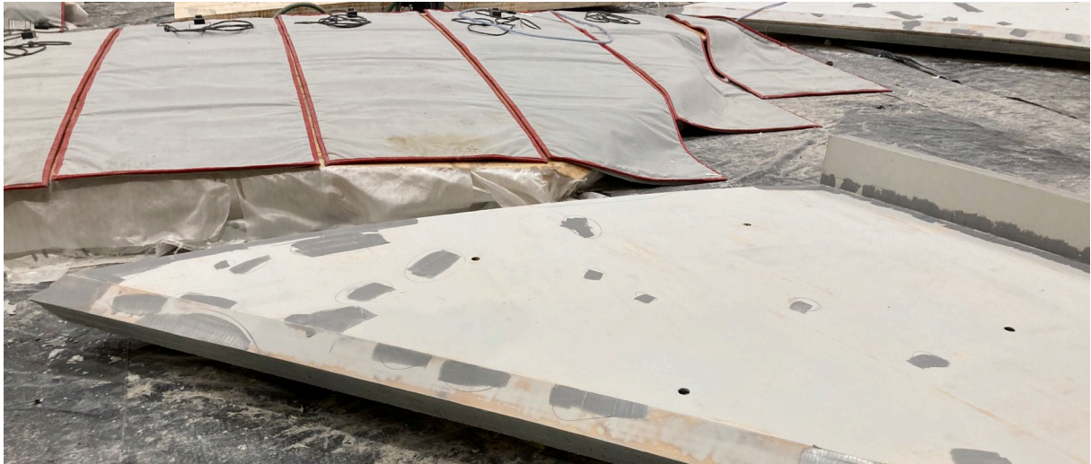
Abb. 16: Vordergrund: Verspachtelung von Unregelmäßigkeiten in der Oberfläche
