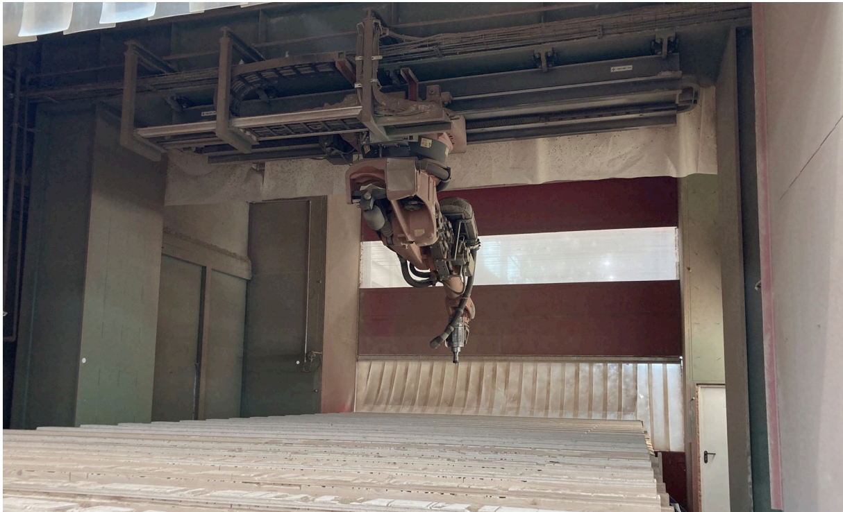
Abb. 13: Portalanlage mit Roboterarm, beweglich in 8 Achsrichtungen im Werk von Züblin Timber; Foto: Stefan Krötsch
