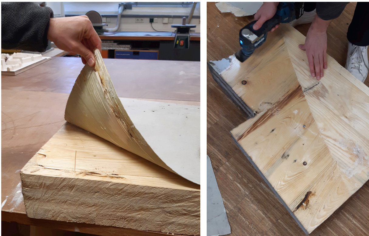
Abb. 34: links und rechts: Entfernen der Beschichtung an einem länger bewitterten Musterstück, Foto: Roman Kreuzer
