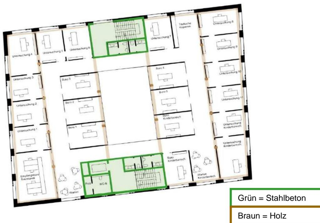
**Grundriss: Holzhybridbau mit zwei Stahlbetonkernen**
