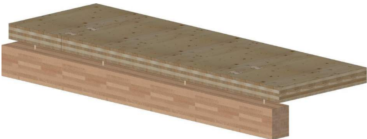
Abbildung 73: Anschluss Decke an Unterzug mit Holzdübeln
